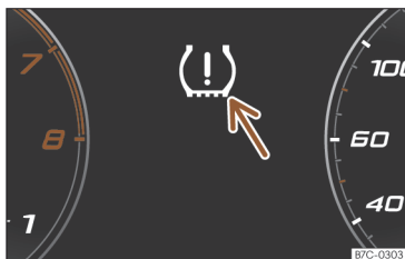
Bild 229 Instrumentpanelen: Varning för minskning av däcktryck.
