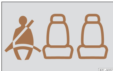
Bild 20 Kombiinstrument: statusindikation för säkerhetsbältena i baksätet.
