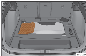
Bild 217 Hybridbilar (PHEV): batteriets placering i bagageutrymmet
