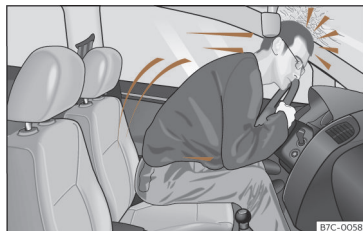
Bild 35 En förare som inte använder säkerhetsbältet kan kastas framåt med en våldsam kraft.
