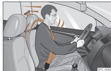
Bild 33 Förare som använder säkerhetsbältet på rätt sätt kastas inte framåt vid en plötslig inbromsning.
