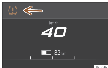
Bild 203 Instrumentpanelen: Varning för minskning av däcktryck.
