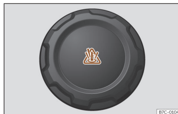
Bild 192 Utrymmet under huven: lock till expansionskärllet för kylvätska.
