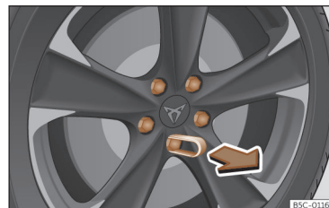
Bild 198 Hjul: hjulsbultar med lock.
