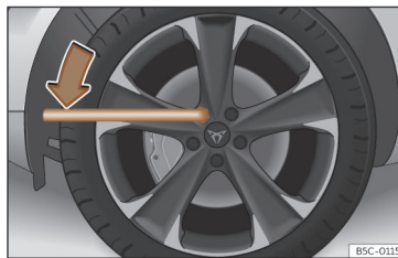
Bild 200 Däckbyte: lossa hjulbultarna.
