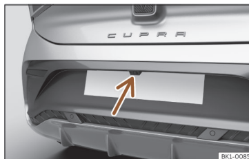
Bild 123 På stötfångaren bak: placering av backassistentens kamera.
