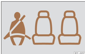
Bild 34 Kombiinstrument: statusindikation för säkerhetsbältena i baksätet.
