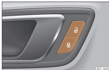
Bild 49 På förardörren: knapp för centrallås.
