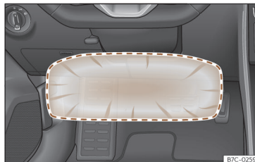
Bild 31 På förarsidan: knärockkuddens utlösningssområde.
