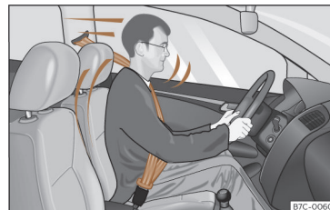
Bild 15 Förare som använder säkerhetsbältet på rätt sätt kastas inte framåt vid en plötslig inbromsning.
