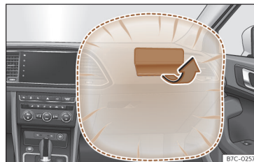
Bild 24 Passagerarairbag fram monterad i instrumentpanelen.
