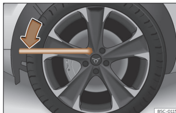
Bild 209 Däckbyte: lossa hjulbultarna.
