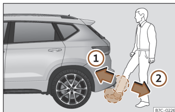
Bild 57 Baklucka med sensorstyrd öppning (Easy Open).
