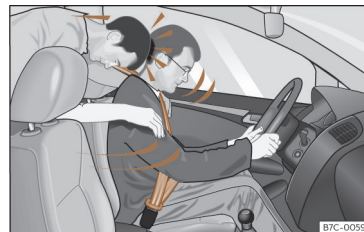
Bild 18 En baksätesspassagerare som inte använder säkerhetsbältet kan kastas framåt med våldsam kraft och träffa föraren som bär säkerhetsbältet.
