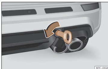
Bild 186 Höger sida på den bakre stötfångaren: fäste för bogserlina monterat.
