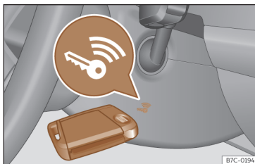
Bild 90 Till höger om rattstängens nödstart.
