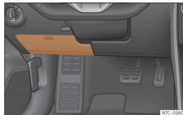
Bild 187 På instrumentbrädan på förarsidan: säkringsdosans lock.
