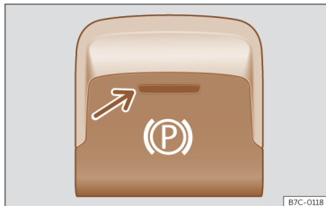
Bild 124 Mittkonsol, nedre del: knapp för elektronisk parkeringsbroms.
